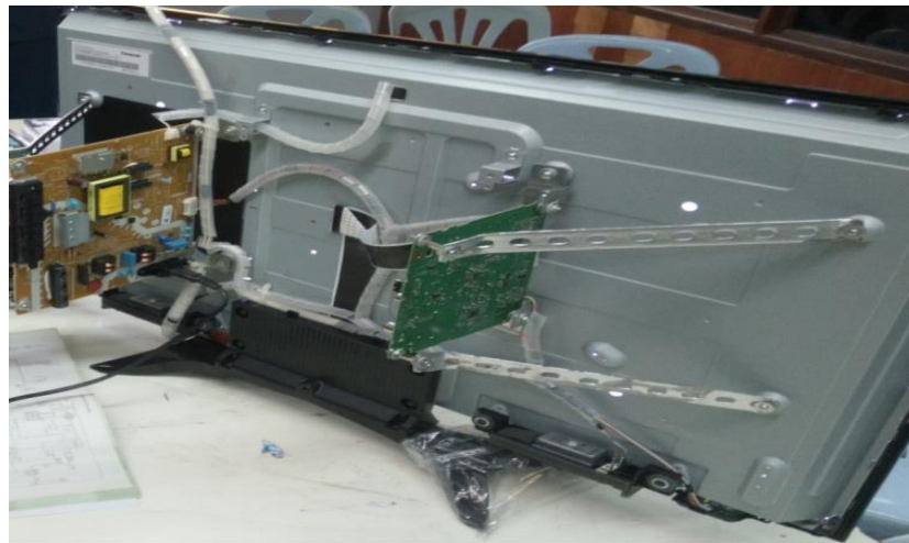
ภาพที่ 3-9 ตำแหน่งของบอร์ดวงจรจอ LCD LED รุ่น TH-32E410T (ชุดฝึกสมรรถนะ) ที่มา : สัญญา โพธิ์วงษ์. (2560)
