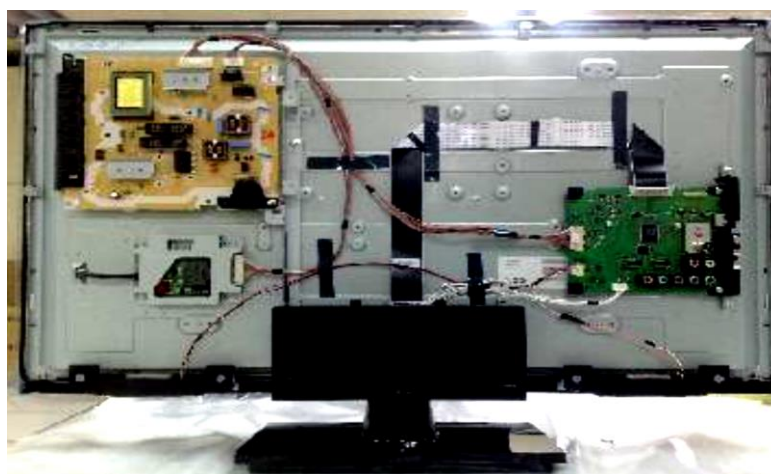
ภาพที่ 3-3 ส่วนประกอบของเครื่องรับโทรทัศน์ ยี่ห้อ Panasonic รุ่น TH-32E410T ที่มา : สัญญา โพธิ์วงษ์. (2560)
