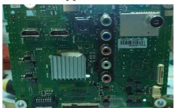
รูปที่ 2 วงจร แผง A-Board ที่มา : สัญญา โพธิ์วงษ์. (2560)
